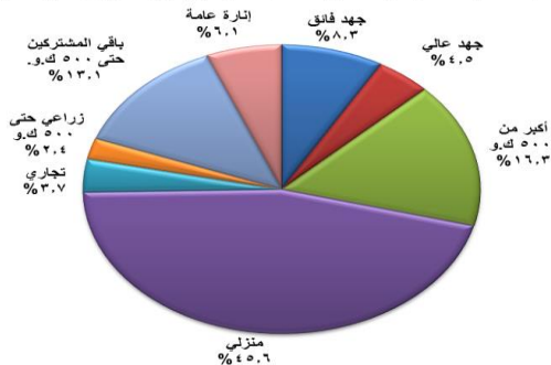
نسبة مشاركة حمل كل فئة من فئات المستهلكين في الحمل الأقصى للشبكة
